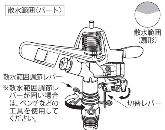
●切替レバーを下げ、散水範囲調節レバーを調節すると部分回転し、扇形面積に散水できます。
