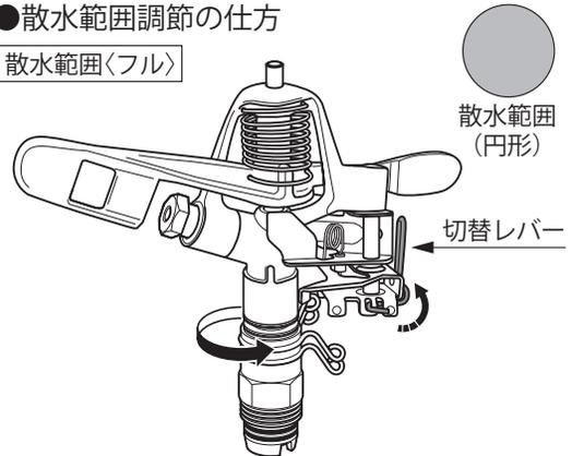
●切替レバーを上げると 360°回転し、円形面積に散水できます。
