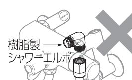
お取り付けの混合栓メーカーに問い合わせの上、金属製のエルボに交換してから本商品を取り付けてください。
