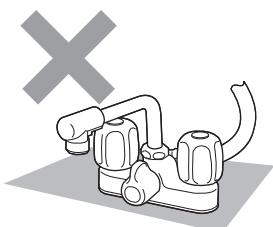
※逆止弁アダプター未内蔵型(逆止弁アダプターの取り付け不可)
