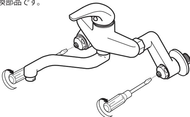
水道メーターの止水栓、または左図のバルブをドライバーで閉じます。
