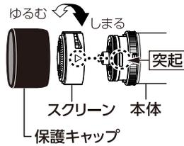
スクリーンの▷印と本体突起部に合わせて差し込み、スクリーンを回して本体へ締め込みます。その後、保護キャップを取り付けます。
