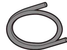
ホース 1.2m (内径:φ12mm、外径:φ16.5mm) ※専用ノズル・本体連結用
