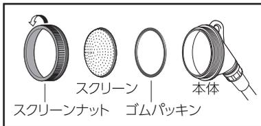
※ヘッド部から水漏れが発生した場合は、一度本体から図の順序で部品を取りはずし、再度取り付けなおしてください。
