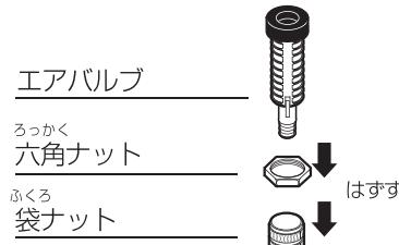
②発射口本体からロックナットをはずし、エアバルブを発射口に入れます。
