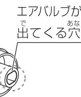
③六角ナットをエアバルブにとおし、ペンチで締め付けます。
