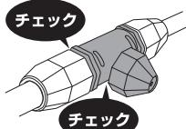
※交換後はノズル A をしっかりと締め込んでください。締め込み不足は水漏れの原因となります。
